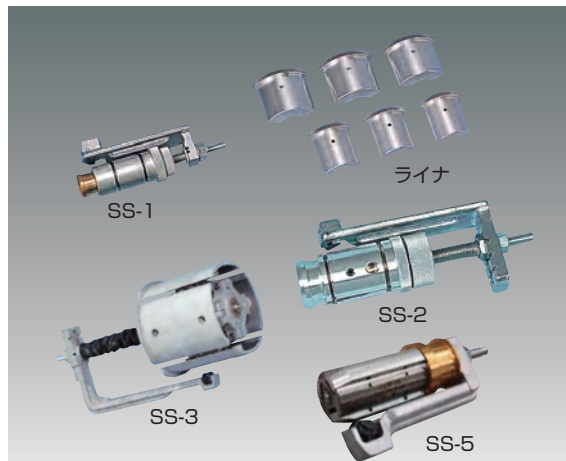
ソケット型継手の融着の際に、融着するPE管等の表面を切削する工具
