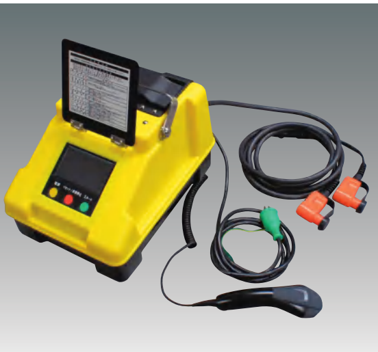
EF継手に接続、通電・融着をする。
